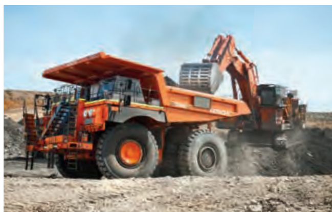
Excavatrices ultra-grandes EX et camions-bennes EH
