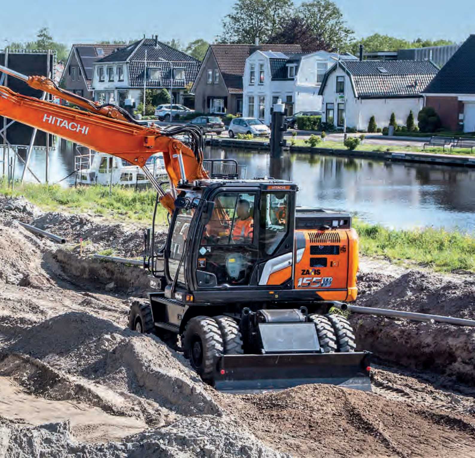
Le système hydraulique HIOS V augmente la vitesse avant et réduit la consommation de carburant.
