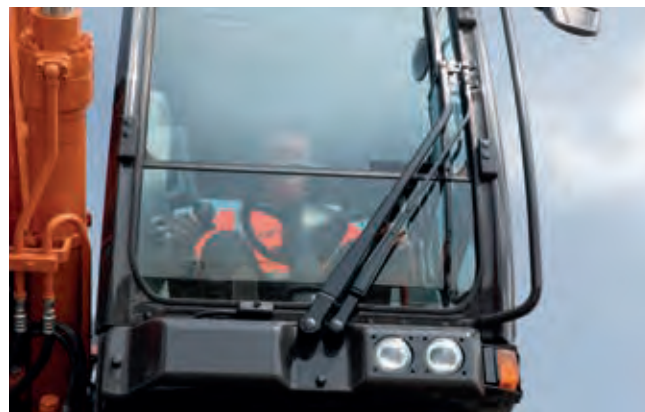
La conception de l'essuie-glace plus large offre une plus grande visibilité.
